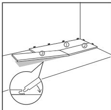
Затем приподнимите укладываемую планку на угол 20–30°. При этом ранее уложенная планка в этом ряду тоже приподнимется, так как их короткие края уже соединены.
