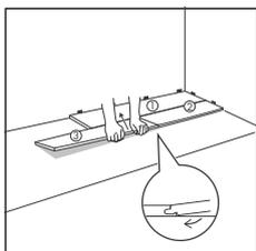
Теперь поместите ОБЕ руки вблизи стыка, как показано на рисунке, и потяните длинную сторону планки к себе. Панели защелкнутся. Можно либо вставить гребень в паз, либо наложить паз на гребень. Вставить гребень в паз — это самый распространенный и простой способ.
